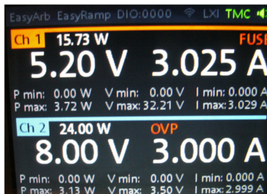
4. ábra Az 1. csatornát elektronikus biztosító tiltja le (FUSE), a másodikat pedig a túlfeszültség-védelmi rendszer (OVP)
