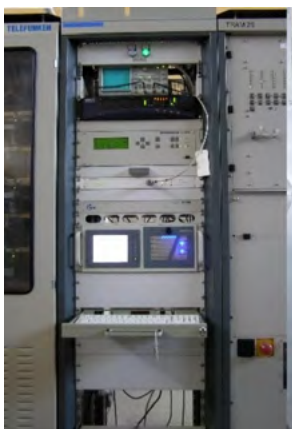
7. ábra Az Antenna Hungária Telefunken gyártmányú DRM-adója a 2008-as kísérletek során
