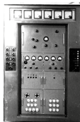
1. ábra Az 1 kW-os kísérleti URH-adó (a Szerző felvétele 1963-ban)
