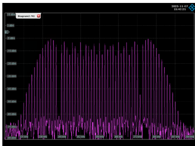
3. ábra Frekvenciamodulált jel spektruma 1 kHz-es szinuszos alapsávi jel esetén
