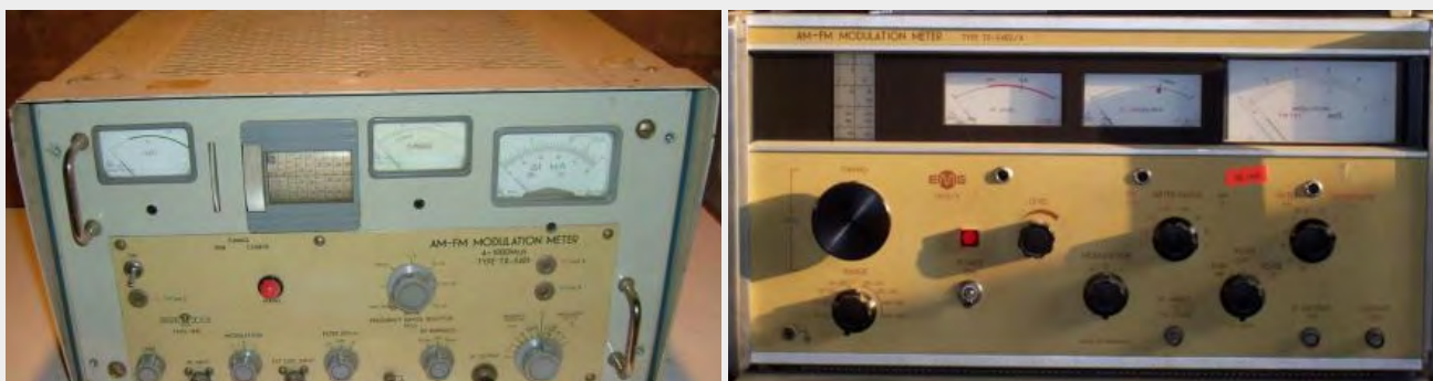
A hazai híradástechnikai ipar fénykorából: Orion-EMG gyártmányú analóg modulációanalizátorok az 1960-es és 80-as évekből (felvételek forrása: https://regimuszerek.khanzi.5mp.eu/ )
