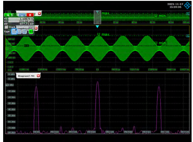
1. ábra Kétoldalsávós, nem-elynyomott vivőjű AM jelalakja és spektruma 1 kHz-es szinuszos alapsávi jel esetén
